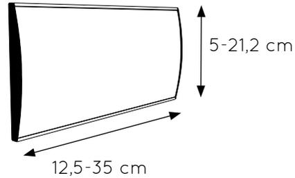
Sistema de señalización compuesto por lamas de aluminio curvadas, tapas y frontales de protección transparentes.
