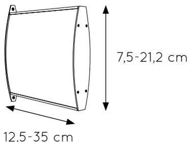
Sistema de señalización compuesto por placas de aluminio curvadas, tapas y frontales de protección transparentes.
