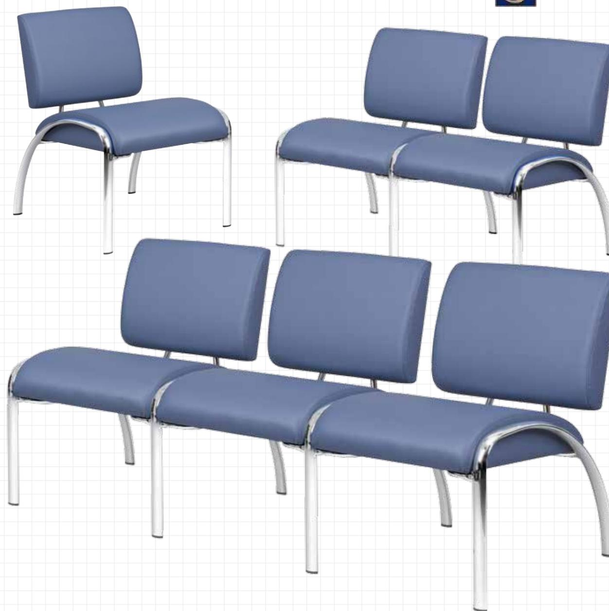
**NEO** es un módulo de espera con acolchado de asiento y respaldo en espuma moldeada de 30 kg/m<sup>3</sup>. Estructura metálica en tubo redondo de 20x1,5 mm y patas en tubo elíptico de 40x20x1,5 mm, con acabado en pintado color negro o gris plata, y opcionalmente, cromada. Sin brazos, el modelo Neo 4, con brazos fijos formando parte de la estructura en tubo elíptico de 40x20x1,5 mm. Opción de montaje en bancada hasta 3 puestos.
